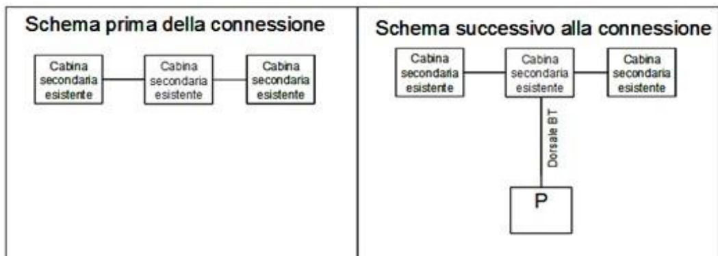
Figura 2 - Inserimento in antenna da cabina MT/BT
