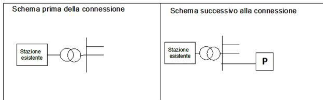
Figura 5- Inserimento in antenna da stazione AT/MT
